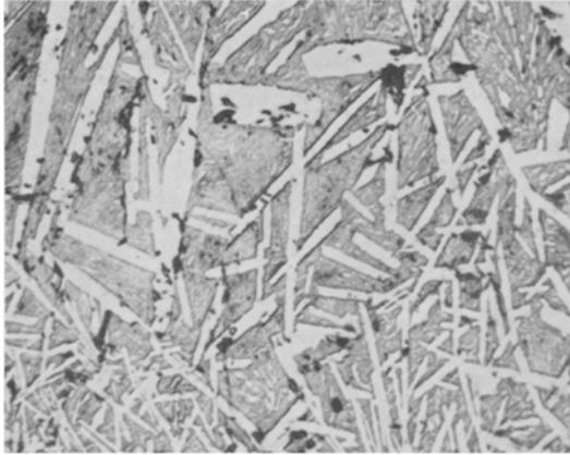
Abb. 6. U—Mo—C (85/15/50) primäres  $UMoC_2$  (helle Spieße) in einer Matrix  $UMoC_2-U-C$ -Eutektikum, ungeätzt.  $\times 400$
